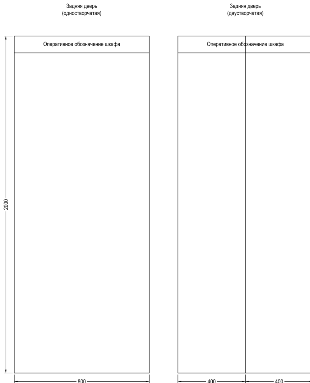
Рисунок 9.6.3 - Общий вид вариантов исполнения задней двери корпоративного шкафа
